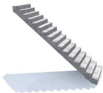
ОДНОМАРШЕВАЯ БЕТОННАЯ ЛЕСТНИЦА
