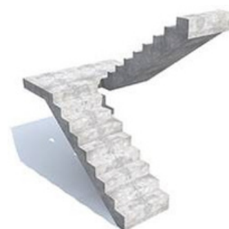
П-ОБРАЗНАЯ БЕТОННАЯ ЛЕСТНИЦА
